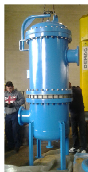
Filtro per acqua di mare in fase costruzione, idoneo per portata di 350 m 3 /h con installate nr. 88 cartucce da 40".
